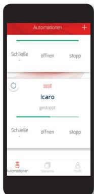
Eine mit U-Link ausgestattete automatisierte Toranlage lässt sich mit den Funktionen „Öffnen“, „Schließen“ und „Stoppen“ bedienen. Über den Aktualisierungs-Button kann der aktuelle Status des Tores angezeigt werden.
