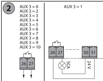
\*\*Con logica inversion direzione di apertura = 000 (DIR=DX) / \*\*With reverse logic, opening direction = 000 (DIR=right)
