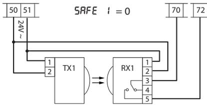
Fotocellule non verificate (Check ogni 6 mesi)
