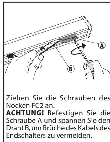
Ziehen Sie die Schrauben des Nocken FC2 an.
