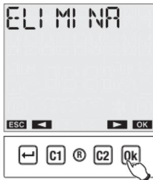
A display compare la scritta ELIMINA seguita dal canale interessato (C1 o C2) e lo strumento si porta nuovamente nello stato di normale funzionamento.
