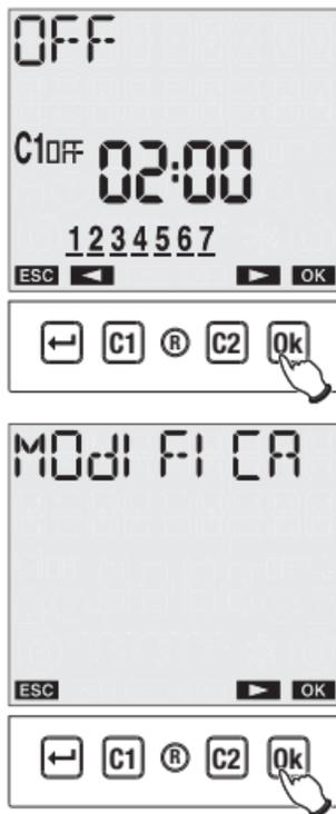
A questo punto è possibile inserire i nuovi parametri del programma. Il parametro oggetto di modifica lampeggia. Usare i tasti **"C1"** e **"C2"** per impostare i valori e **"Ok"** per confermare oppure il tasto **"↵"** per uscire senza modificare.
