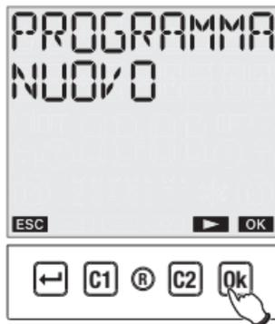
Scegliere il canale sul quale effettuare la programmazione tramite i tasti “C1” e “C2”.
