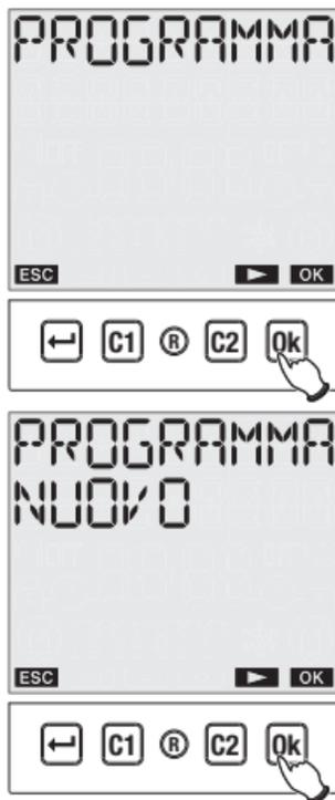
Scegliere il canale sul quale effettuare la programmazione tramite i tasti “C1” e “C2”.
