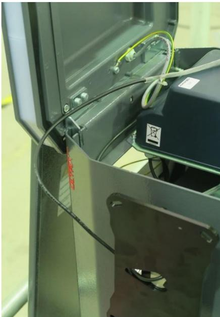
Falls eine Schrankenbaumbeleuchtung verwendet wird, das schwarze 3-adrige Kabel vom LED-Streifen nun von der Rückseite des Flansches durch die Nut der Antriebswelle in das Gehäuse führen.
